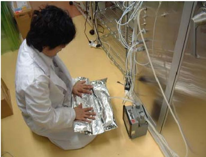
バック内の汚染ガスを大型チャンバー（気積：5.54[m<sup>3</sup>]）に供給する。
