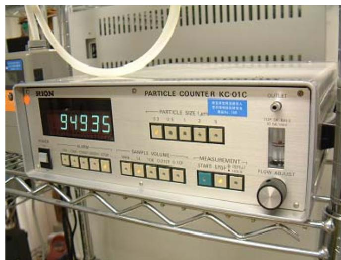
パーティクルカウンターを用いて、機器の吸入・排出口における粒径別粉じん濃度を測定する。
